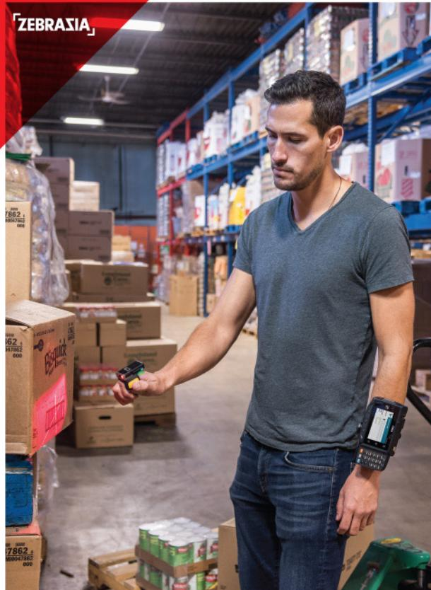
اسکنرهای پوشیدنی بارکد، ابزاری نوآورانه برای افزایش بهره‌وری و کاهش زمان اسکن در محیط‌های صنعتی، انبارداری و لجستیکی هستند. این دستگاه‌ها که معمولاً به صورت دستکش، مج‌بند یا انگشتی طراحی می‌شوند، به اپراتور این امکان را می‌دهند که بدون نیاز به در دست گرفتن دستگاه، بارکد کالاهای را با یک حرکت ساده اسکن کند. این مزیت به ویژه در فرآیندهای پرچم و پرتحک مانند انبارگردانی، بسته‌بندی یا آماده‌سازی سفارش‌ها بسیار موثر است.
